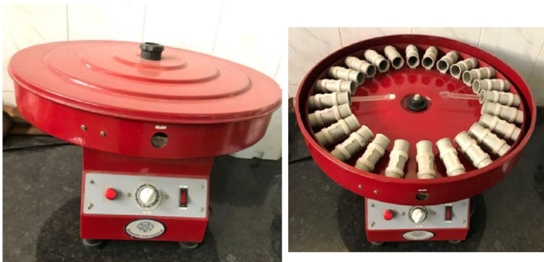
ਤਸਵੀਰ 2.25: ਜਰਬਰ ਅਪਕੇਂਦਰਿਤਰ ਮਸ਼ੀਨ (Centrifuge machine) ਜਾਂਚ ਦਾ ਤਰੀਕਾ
